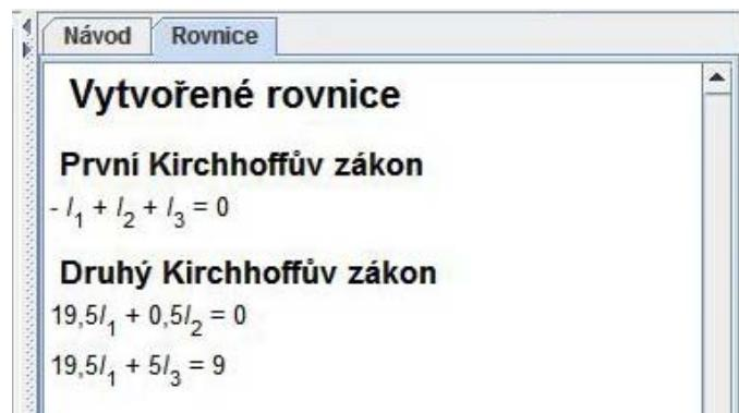
Obrázek 4 – Vytvořené rovnice zobrazené v informačním panelu
